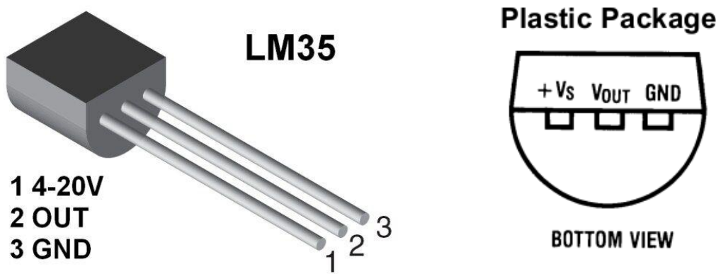
شکل ۱. ساختمان یک حسگر دما LM35
